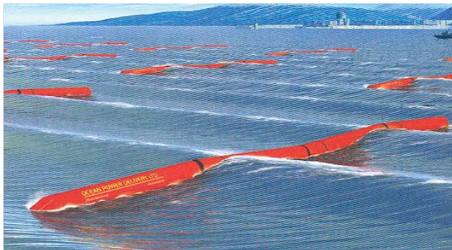
Rajah 5: Alat Penukar Kuasa Pelamis yang digunakan untuk menghasilkan tenaga elektrik
