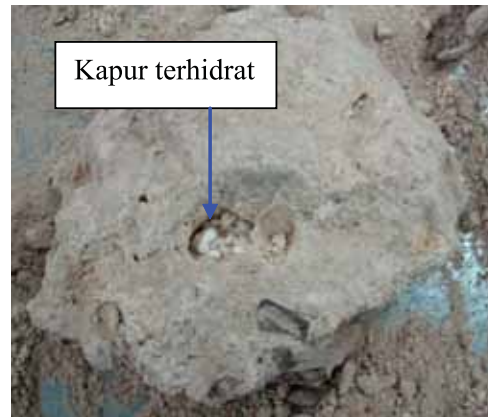
Rajah 5: Kapur terhidrat terperangkap di dalam mortar kapur bersejarah
